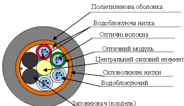
Конструкція кабелю в розрізі
